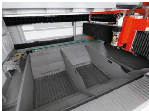
Convoyeurs avec système WAVE-BELT dans la machine. WAVE-BELT conveyor within the machine.
