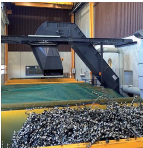
Séparation des copeaux et répartition sur une décortiqueuse. Chip separation and distribution on a peeling machine.
