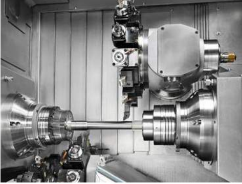
Revêtement d'espace de travail dans centre de tournage-fraisage. Work area cladding on a turning and milling center
