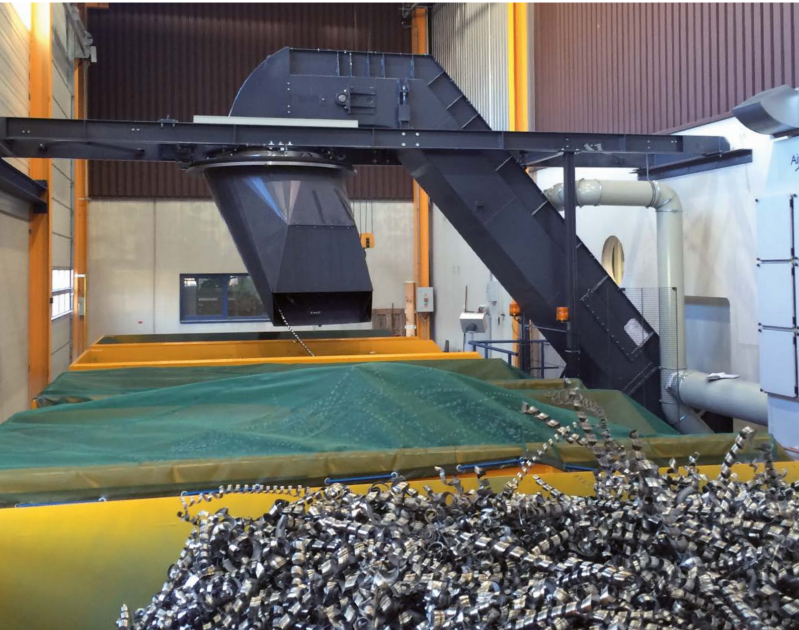
Spänentrennung und Verteilung an einer Schälmaschine. Chip separation and distribution on a peeling machine.
