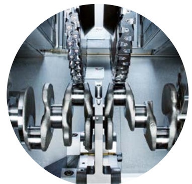
Die BOEHRINGER 221/226 Cx ist für die Bearbeitung von Kurbelwellen bis zu einer Gesamtlänge von 550/750 mm konzipiert.
