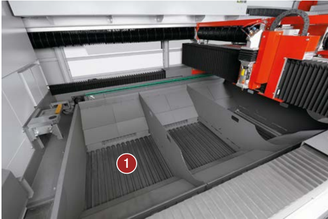
WAVE-BELT Förderer innerhalb der Maschine. WAVE-BELT conveyor within the machine.
