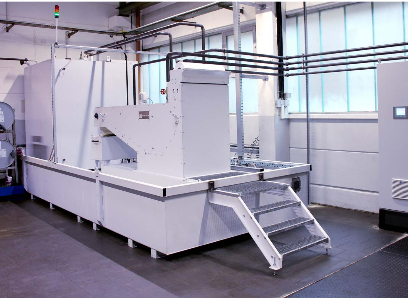
Bandfilteranlage mit Rein-/Puffertank und Steuerschrank. Belt filter system with clean/buffer tank and control cabinet.
