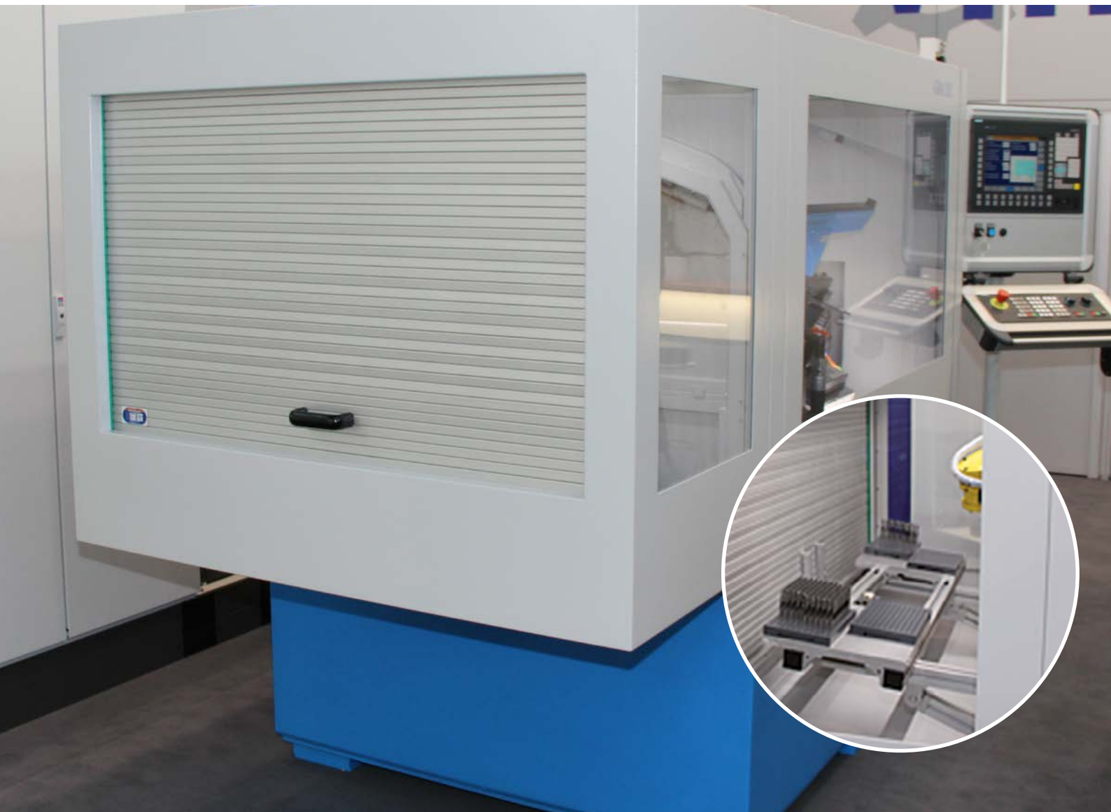
Manuell betätigtes Rolltorsystem auf Basis der Gliederschürze Ausführung 2N. Manually operated shutter-door system based on the link apron version 2N.
