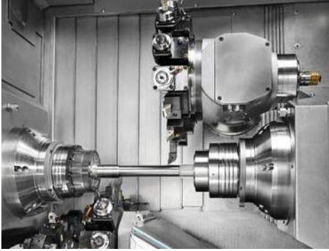
Arbeitsraumverkleidung an einem Dreh- Fräszentrum Work area cladding on a turning and milling center
