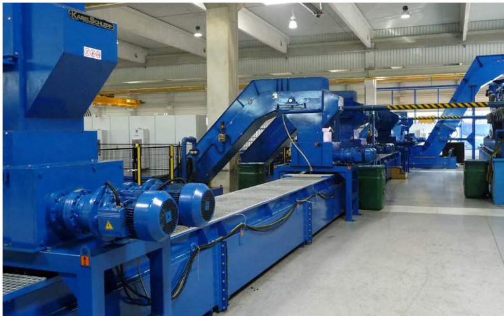
Zentrale Späneentsorgung und Aufbereitung. Central chip disposal and processing.
