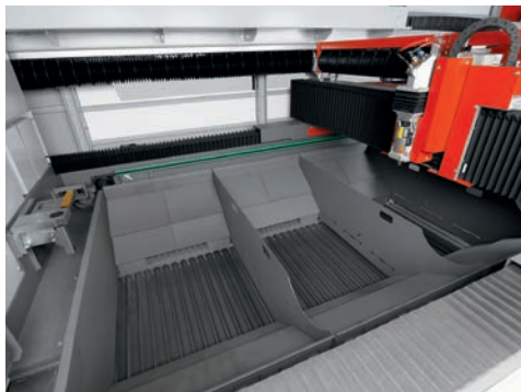
WAVE-BELT Förderer innerhalb der Maschine. WAVE-BELT conveyor within the machine.
