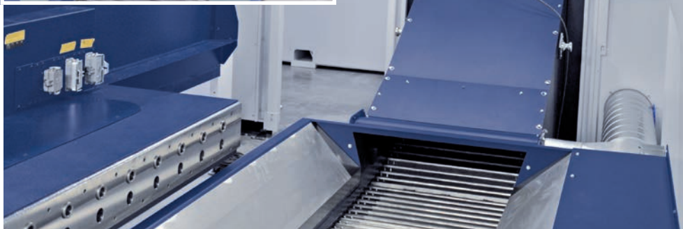
Fördersystem-Konfiguration an einer Laserschneidmaschine. Conveyor system configuration on a laser cutting machine.
