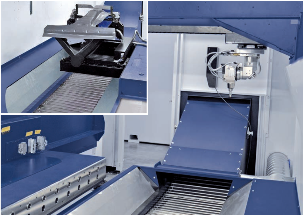
Fördersystem-Konfiguration an einer Laserschneidmaschine. Conveyor system configuration on a laser cutting machine.
