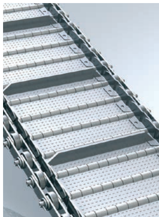
Scharnierband mit Sicken zum Transport von „klebrigen“ Teilen
