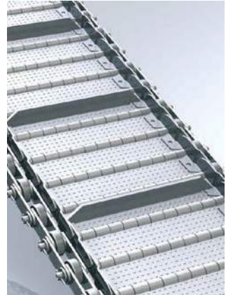
Scharnierband mit Sicken zum Transport von „klebrigen“ Teilen
