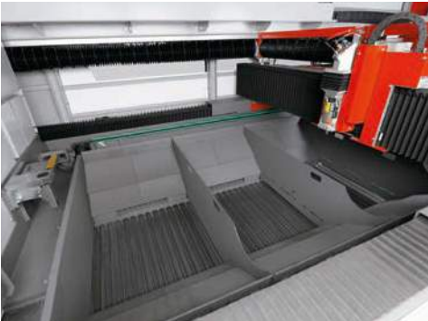
WAVE-BELT Fördere innerhalb der Maschine. WAVE-BELT conveyor within the machine.
