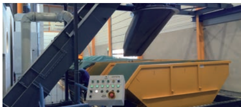
Commande manuelle ou entièrement automatique du remplissage. Manual or fully automated control of the filling.
