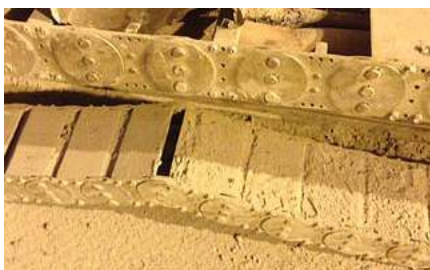
Exemple négatif : Système de capot en cas de forte présence de poussière
