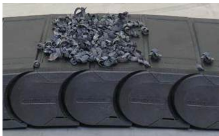
Exemple : Système de capot avec copeaux
