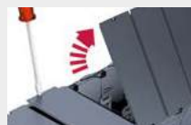
Déverrouillage simple du couvercle avec un tournevis
