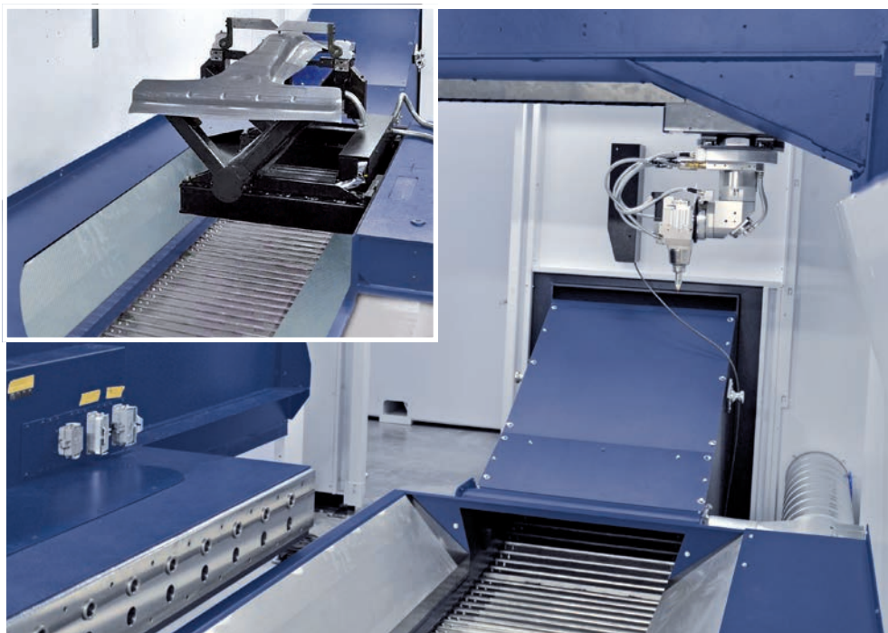
Configuration d'un système de convoyage sur une machine de découpage à laser. Conveyor system configuration on a laser cutting machine.
