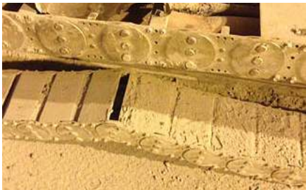
Negativbeispiel: Deckelsystem bei hohem Staubaufkommen
