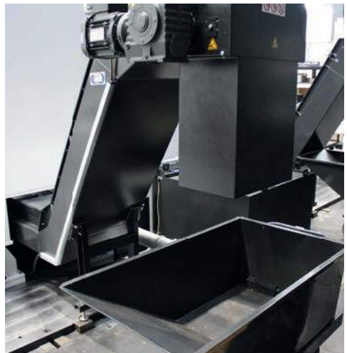
Eine Kombination aus Längs- und Querförderer entsorgt die Späne an der Kurbelwellenbearbeitungsmaschine von MAG IAS. A combination of longitudinal and cross conveyors disposes of the chips on the crankshaft machining centers from MAG IAS.
