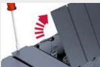
Deckel einfach mit einem Schraubendreher entriegeln
