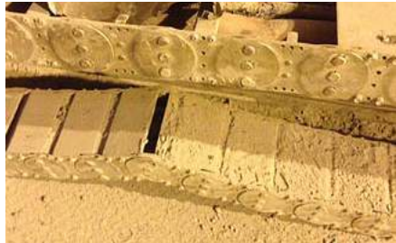
Negativbeispiel: Deckelsystem bei hohem Staubaufkommen
