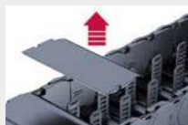
Deckel vom Kettenglied lösen
