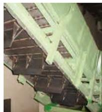
■ Sonderausführung an einer Saumschere mit einer Bandbreite von 900 mm
