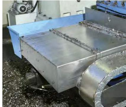
■ Teleskop-Abdeckung an einer Fräsmaschine
