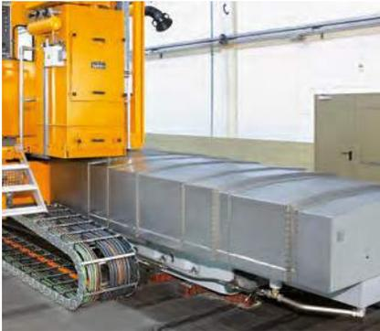
■ Teleskop-Abdeckung an einer Drehmaschine
