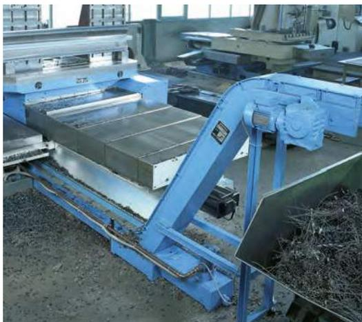
■ Standard-Scharnierbandförderer an einem CNC-Bohrwerk
