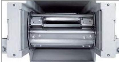
■ Austausch einzelner Scharnierbandplatten am Abwurf.
