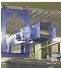
■ Scharnierbandförderer zur Beschickung einer Bunkeranlage
