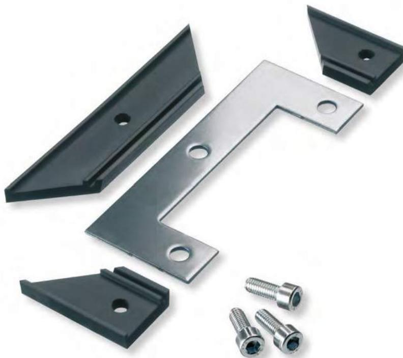
Sogenannte „**gegossene Abstreifer**“ sind Abstreifer, bei denen auf ein Trägerprofil aus Stahl ein Neopren-Kautschuk aufvulkanisiert wird. Dies geschieht in speziell hergestellten Spritzformen. Größere Stückzahlen sind Voraussetzung, da die Werkzeugkosten auf die Anzahl der zu produzierenden Teile umgelegt werden müssen.
