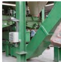
■ Kratzerförderer unter einer Bunkeranlage für Aluminium-Späne
