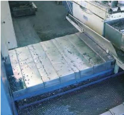
■ Teleskop-Abdeckung mit Flachform an einem Bohrwerk
