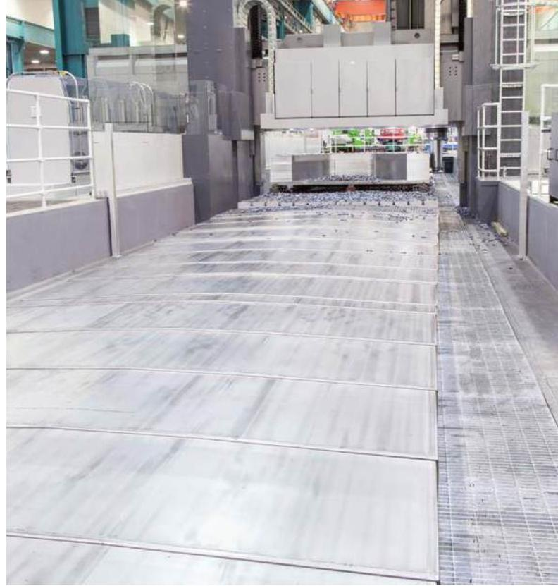
mitnahme gebaut werden. Bei höheren Geschwindigkeiten führen die unvermeidlichen Anschlagimpulse zu Vibrationen und deutlich hörbaren Anschlaggeräuschen. Teleskop-Abdeckungen mit Scherenmechanik sorgen für einen gleichmäßigen und ruhigen Lauf der einzelnen Kästen.
