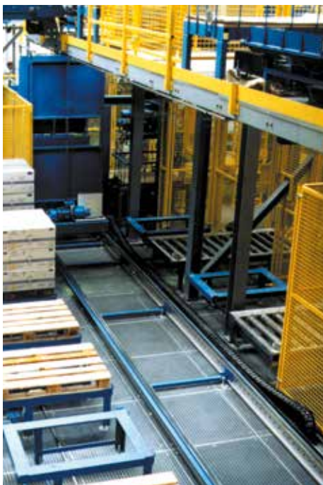
Catene Mono su impianto automatico
