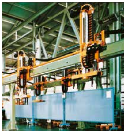
Catene Mono su impianto automatico
