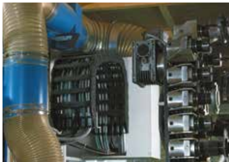
Uniflex su macchina lavorazione legno
