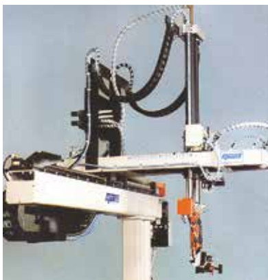
Catene Uniflex e MK su manipolatore
