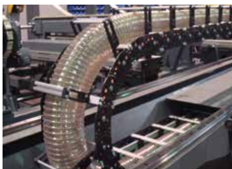
Catena acciaio LS 1050 con passaggio maggiorato su macchina tagliatubi
