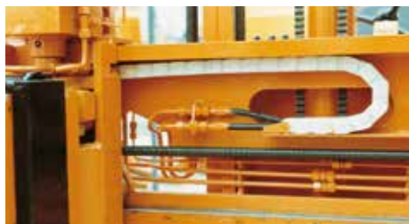
Catena Mono su trasloelevatore
