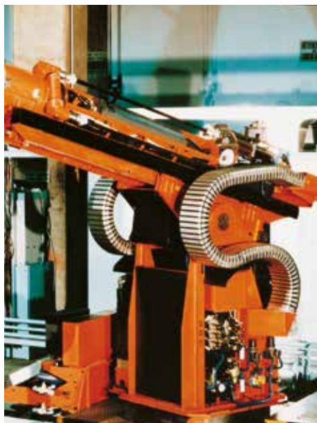
Conduflex su Robot Bisiach e Carrù
