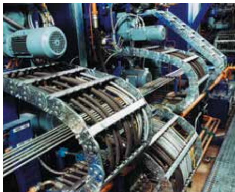
Catene Acciaio su macchina automatica
