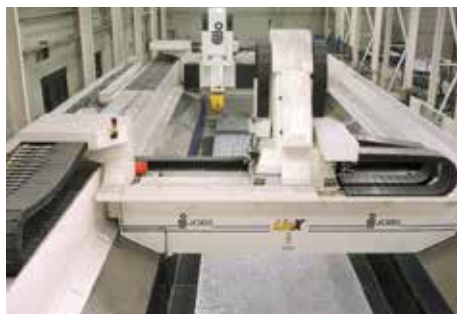
Catene MC e guaine MT su macchina utensile
