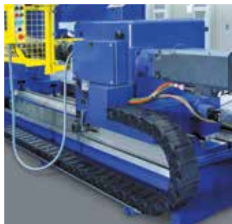
Catene MC e guaine MT su macchina utensile
