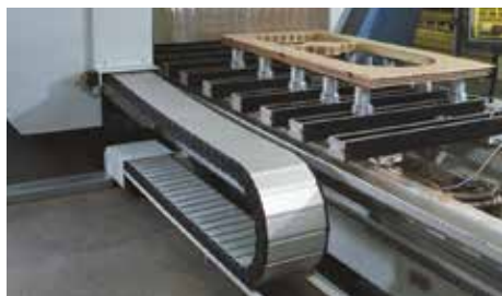
MT variante RMD su macchina lavorazione legno
