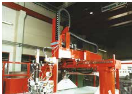
Catene Uniflex su manipolatore
