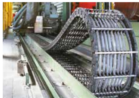
Catene Tipo MC0650 su impianto d'imballaggio
