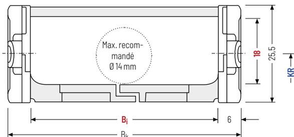
**i** Le diamètre maximal des câbles dépend fortement du rayon de courbure et du type de câble souhaité. Veuillez nous contacter.
