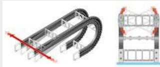
**3D-Bewegungen: Der Mitnehmeranschluss ist seitlich verschiebbar und kann bis zu ± 30° verdreht werden**
