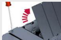
Deckel einfach mit einem Schraubendreher entriegeln
