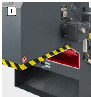
Sicherheitstechnik am unteren Einzug verhindert das Einziehen von Teilen.
