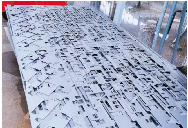
Restgitter nach dem Laserprozess zur Entsorgung Skeletons after the laser process for disposal
