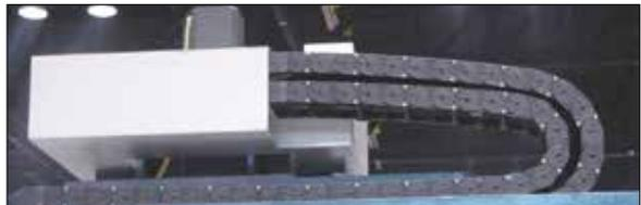
Per questa disposizione è necessario assicurarsi che le catene portacavi possano muoversi liberamente. Cio' significa mantenere una distanza sufficiente fra il tratto superiore (min.20 mm, in funzione della catena portacavi) e le curvature della catena (min. metà dell'altezza della maglia catena).
