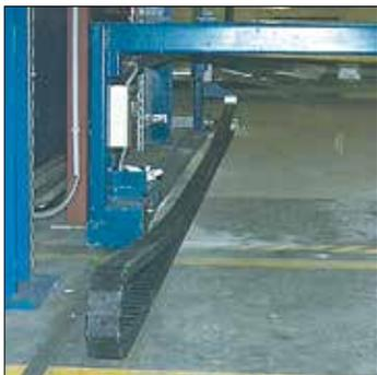
L'immagine qui a fianco rappresenta un'applicazione presso un magazzino automatico. La catena si appoggia direttamente sul fondo del pavimento in cemento. Il tratto superiore della catena si appoggia sul tratto inferiore e su di esso scorre per tutta la lunghezza della corsa.
