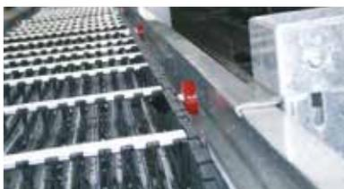
I rulli scorrono sulle rotaie di guida e non interferiscono con altri rulli. Cuscinetti a sfera e superficie dei rulli in PU garantiscono in aggiunta un movimento con vibrazioni e rumorosità ridotte.
