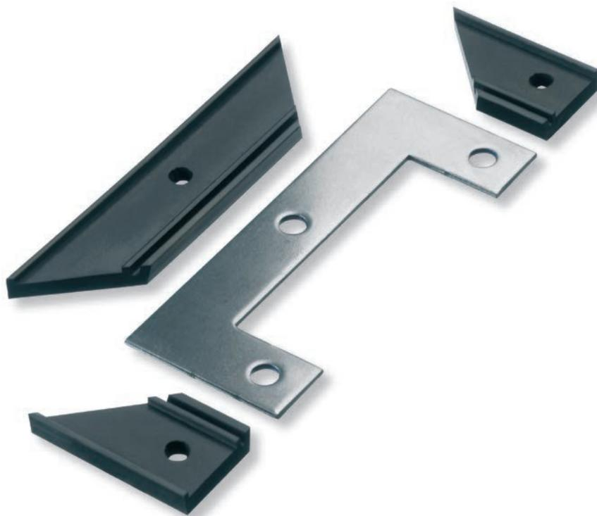
Les dénommés « racleurs moulés » sont des racleurs dans lesquels un caoutchouc néoprène est vulcanisé sur un profil de support en acier. Des moules à injection spécialement fabriqués sont utilisés. Des quantités plus importantes sont nécessaires, car les coûts de l'outillage baissent en fonction du nombre de pièces à produire.
