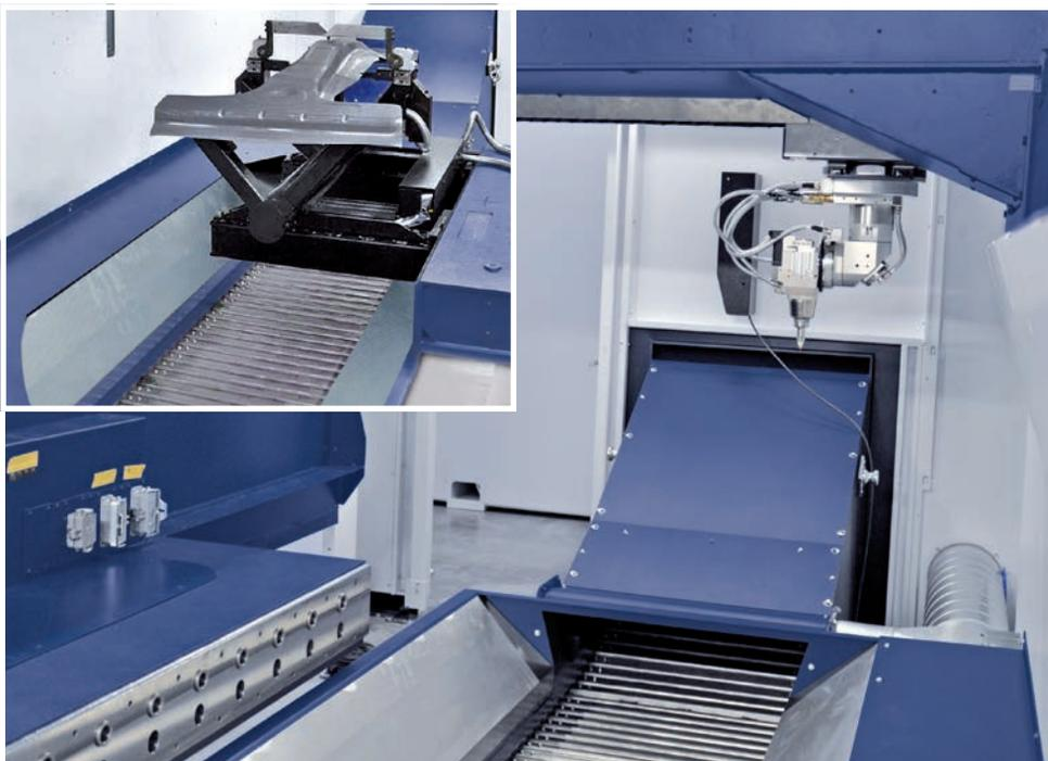
Configuration d'un système de convoyage sur une machine de découpage à laser.
