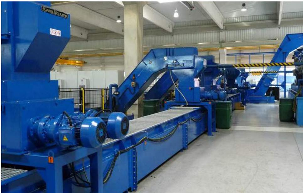
Élimination centralisée des copeaux et traitement.
