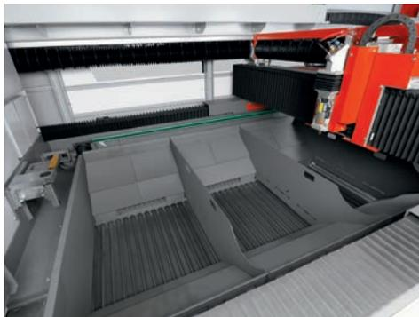
Convoyeurs avec système WAVE-BELT dans la machine.
